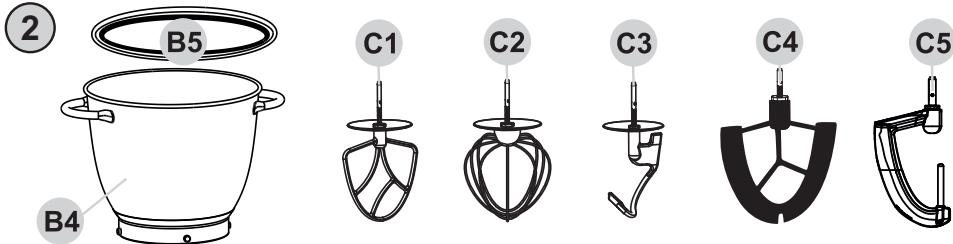
Nástavce **C1 - C5** jsou vhodné pro použití s mísami **B1** i **B4**. Vzhledem k menšímu objemu mísy **B4** je potřeba upravit množství zpracovávaných surovin. Údaje pro nástavec **C4** jsou shodné s mísící metlou **C1** a pro nástavec **C5** jsou shodné s hnětacím hákem **C3**. Zároveň platí, že toto množství odpovídá přibližně polovině množství uváděné pro misu **B1**.
