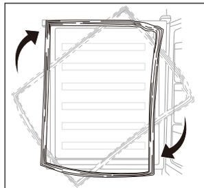
12. Vraťte dveře zpět. Než definitivně dotáhnete šrouby, zkontrolujte, zda dveře horizontálně i vertikálně lícují a zda těsnění po všech stranách správně dosedá.
