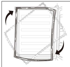
12. Vráťte dvere späť. Než definitívne dotiahnete skrutky, skontrolujte, či dvere horizontálne aj vertikálne doliehajú a či tesnenie po všetkých stranách správne dosadá.
