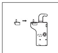
5. Sejměte kryt v horní části horních dvírek a přesuňte spojovací konektor z pravé strany na levou stranu a poté kryt nasadte zpět.
