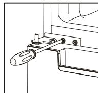
15. Nasadte horní dvířka, ujistěte se, že jsou dvířka zarovnána se skříní chladničky a správně těsní. Poté dvířka upevněte ke skříni pečlivým přišroubováním horního závěsu.
