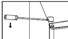
4. Przesuń osłonę otworu na zawias z lewej na prawą stronę. Następnie podnieś górne drzwi i umieść je na miękkiej powierzchni, aby zapobiec zarysowaniom.
