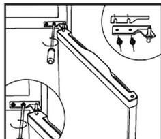
6. Przesuń dwa pokrywy środkowych otworów z lewej na prawą stronę.
