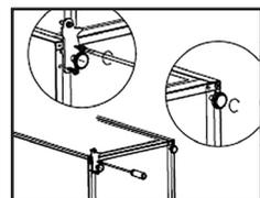
10. Postaw lodówkę i zamontuj drzwi na dolnym zawiasie. Upewnij się, że bolec dolnego zawiasu jest włożony w dolny otwór drzwi. Następnie przesunij pokrywę otworu dolnych drzwi z lewej strony na prawą stronę.
