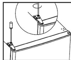
13. Zaklapněte kryt závěsů a kryt otvorů na horní části chladničky.
