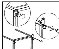
8. Odkręć i wyjmij bolec dolnego zawiasu, obróć zawias i wkręć bolec z powrotem.
