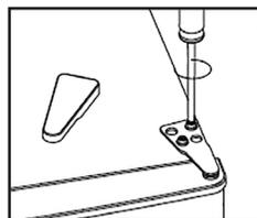
2. Odskrutkujte horný záves pomocou križového skrutkovača.
