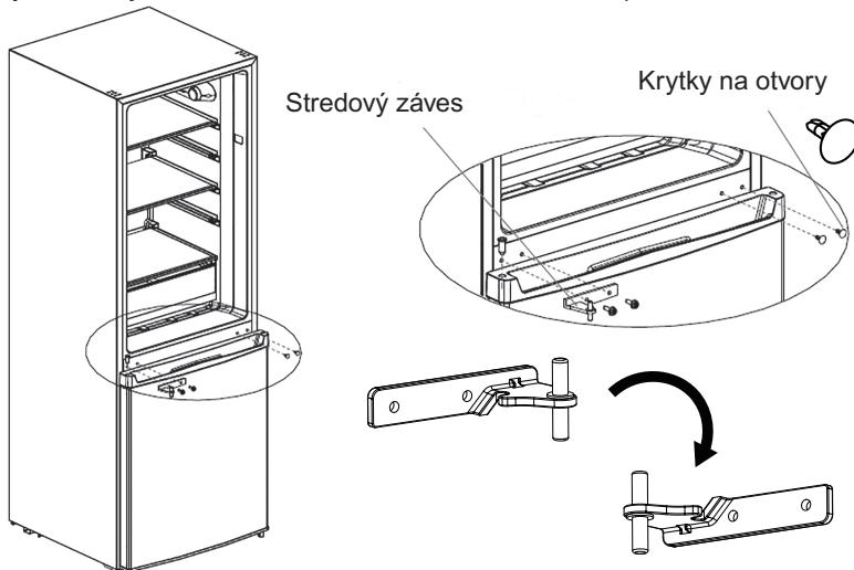
7. Dvierka chladničky nasadte na stredový záves, namontujte horný záves, krytku horného závesu a krytku na otvor na protifahlej strane.
