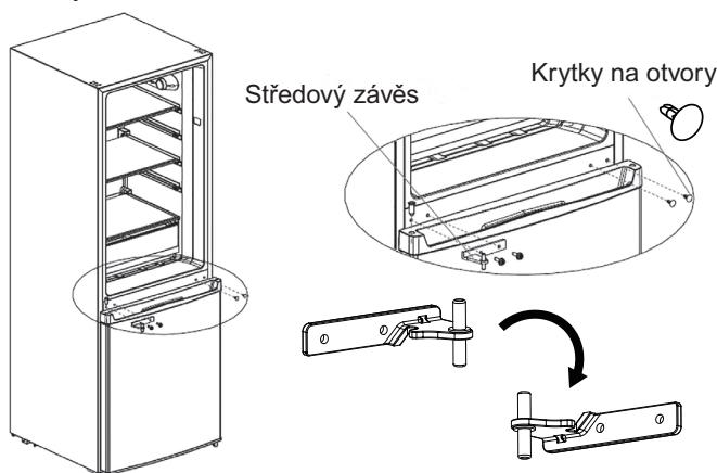
7. Dvířka ledničky nasadte na středový závěs, namontujte horní závěs, krytku horního závěsu a krytku na otvor na protější straně.
