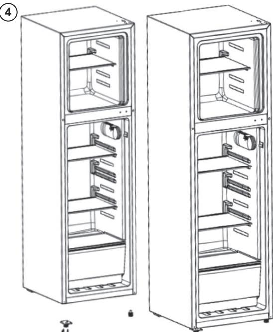
5. Umístěte dvířka lednice, ujistěte se, že osa spodního závěsu a otvor na osu na spodní levé straně spotřebiče dobře drží a správně zapadají. Nyní jsou dvířka lednice v podstatě připevněná; poté za pomocí dvou šroubů připevněte středový závěs na levou stranu skříně; pak středový závěs utáhněte.
