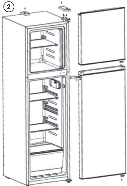
3. Wykręcić trzy śruby, które trzymają dolny zawias pod prawą stroną lodówki. Zdjąć dolny zawias i nastawną nóżkę pod dolny zawiasem pod prawą stroną lodówki. Jednocześnie kluczem wykręcić śruby, które trzymają oś zawiasu; następnie zdjąć nastawną nóżkę na spodniej lewej stronie pod lewą stroną lodówki.
