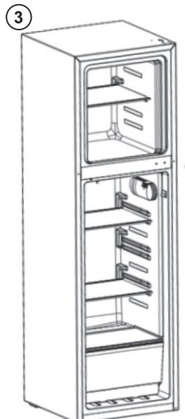
4. Stavitevnou nožičku, která je původně na levé straně, přišroubujte na odpovídající pozici na pravé straně pod skříní. Spodní závěs otočte o 180 stupňů a osu spodního závěsu připevněte do otvoru pro dolní závěs. Poté závěsy i šrouby utáhněte; stejně tak stavitevnou nožičku, která je původně na pravé straně, přišroubujte na odpovídající místo na levé straně pod skříní; poté utáhněte šrouby, které drží spodní závěs.
