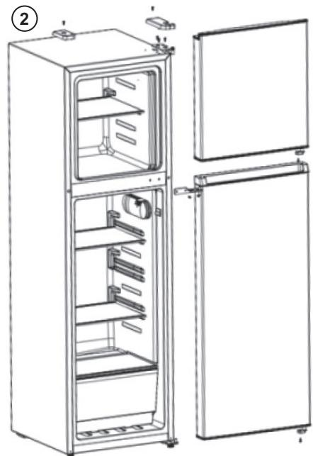
3. Vyšroubujte tři šrouby, které drží spodní závěs pod pravou stranou skříně. Sejměte spodní závěs a stavitevnou nožičku pod spodním závěsem pod pravou stranou skříně. Současně klíčem vyšroubujte šrouby, které drží osu závěsu; poté sejměte stavitevnou nožičku na spodní levé straně pod levou stranou skříně.
