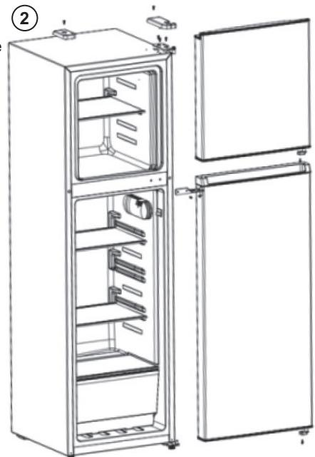
3. Odstráňte tri skrutky, ktoré držia spodný záves pod pravou stranou skrine. Odstráňte spodný záves a nastaviteľnou nožičku pod spodným závesom pod pravou stranou skrine. Súčasne kľúčom vyskrutkujte skrutky, ktoré držia osu závesu; potom zložte staviteľnú nožičku na spodnej ľavej strane pod ľavou stranou skrine.
