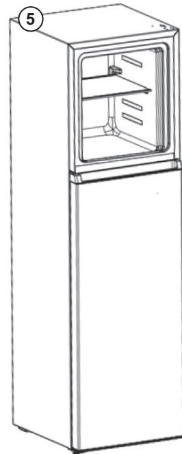
6. Umístěte dvířka mrazničky, ujistěte se, že osa středního závěsu a otvor na osu na spodní levé straně spotřebiče dobře drží a správně zapadají; nyní jsou dvířka mrazničky v podstatě připevněná. Poté použijte šrouby, které jste vyjmuli v prvním kroku, k připevnění horního závěsu na levou stranu skříně; nasadte kryt horního závěsu a přišroubujte.
