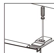
7. Zložte horné dvierka, vyberte skrutky zo stredného závesu krízovým skrutkovačom, potom zložte spodné dvere.
