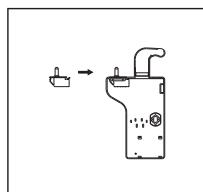
5. Sejměte kryt v horní části horních dvířek a přesuňte spojovací konektor z pravé strany na levou stranu a poté kryt nasadte zpět.
