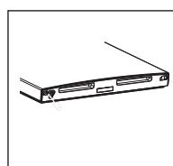
13. Vyjměte dveřní těsnění z dveří chladničky i mrazničky a poté je (po otočení o 180°) vraťte na původní místo.
