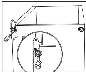
**11. Helyezze vissza az ajtót! Mielőtt teljesen rögzíti a csavarokat, ellenőrizze az ajtó függőleges és vízszintes oldalát és a tömítés megfelelő működését!**
