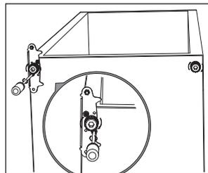
11. Vraťte dveře zpět. Než definitivně dotáhnete šrouby, zkontrolujte, zda dveře horizontálně i vertikálně lícuji a zda těsnění po všech stranách správně dosedá.
