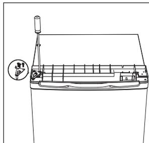
12. Nasadte horní kryt a upevněte jej pomocí 2 šroubů na zadní straně.
