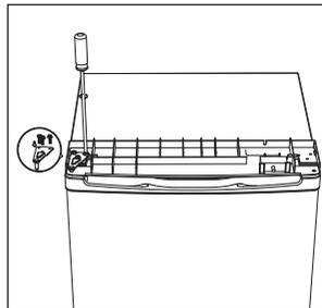
12. Nasadte horný kryt a upevnite ho pomocou 2 skrutiek na zadnej strane.
