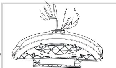
3. Umístěte mopovací nástavec na své místo vysavače. Na spodní straně nástavce jsou 4 výstupky a ty nasměrujte do otvorů ve vysavači. Mírně na nástavec zatlačte až zacvakne do vysavače. Pro vyjmutí nástavce jej uchopte a opačným směrem jej za použití mírné síly vyjměte.
