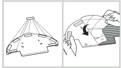
2. Öffnen Sie den Gummistopfen **G1** und füllen Sie den Moppaufsatz mit Wasser.
