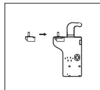
5. Sejměte kryt v horní části horních dvířek a přesuňte spojovací konektor z pravé strany na levou stranu a poté kryt nasadte zpět.
