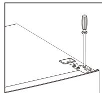
3. Vyjměte čep pomocí šroubováku a otočte držák závěsu. Poté opět připevněte čep k držáku závěsu.
