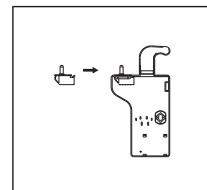
5. Odstráňte kryt v hornej časti horných dvierok a presuňte spojovací konektor z pravej strany na ľavú stranu a potom kryt nasadte späť.
