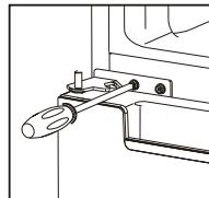
15. Nasaděte horní dvírka, ujistěte se, že jsou dvírka zarovnána se skříní chladničky a správně těsní. Poté dvírka upevněte ke skříni pečlivým přišroubováním horního závěsu.
