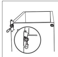
11. Vraťte dveře zpět. Než definitivně dotáhnete šrouby, zkontrolujte, zda dveře horizontálně i vertikálně lícují a zda těsnění po všech stranách správně dosedá.
