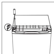
12. Nasaděte horní kryt a upevněte jej pomocí 2 šroubů na zadní straně.
