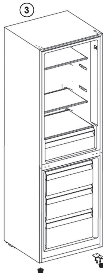
4. Nastawną nóżkę, która jest pierwotnie na lewej stronie, przykręcić na odpowiadającej stronie po prawej stronie pod lodówką. Zawias dolny obrócić o 180 stopni i oś dolnego zawiasu umocować do otworu na dolny zawias. Następnie dokręcić zawiasy i śruby; tak samo nastawną nóżkę, która była pierwotnie na prawej stronie, przykręcić w odpowiednim miejscu na lewej stronie pod lodówką; następnie dokręcić śruby, które trzymają dolny zawias.
