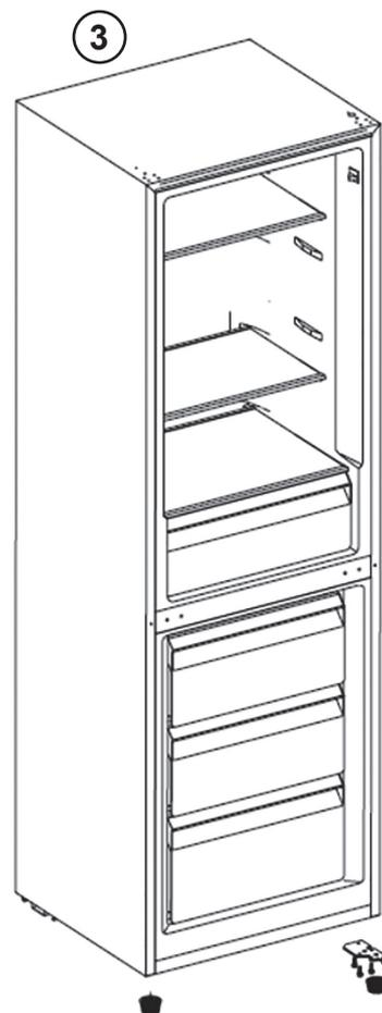
4. Staviteľnú nožičku, ktorá je pôvodne na ľavej strane, priskrutkujte na zodpovedajúcu pozíciu na pravej strane pod skriňou. Spodný záves otočte o 180 stupňov a os spodného závesu pripevnite do otvoru pre dolný záves. Potom závesy aj skrutky utiahnite; rovnako tak staviteľnú nožičku, ktorá je pôvodne na pravej strane, priskrutkujte na zodpovedajúce miesto na ľavej strane pod skriňou; potom utiahnite skrutky, ktoré držia spodný záves.
