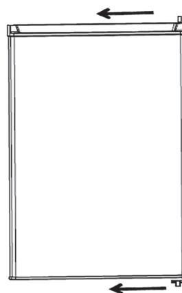
8) Zvisle nasadťte dvierka na spodný záves. Upevnite horný záves a horný kryt chladničky.
