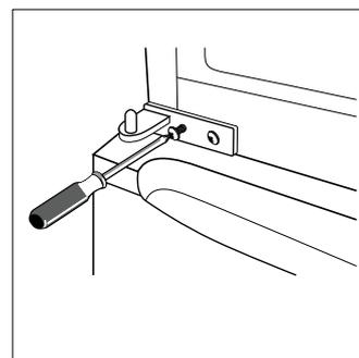
9. Csavarozza le a felfüggesztés csapját és fordítsa el a felfüggesztést. Ezután a felfüggesztés csapját helyezze ismét vissza.
