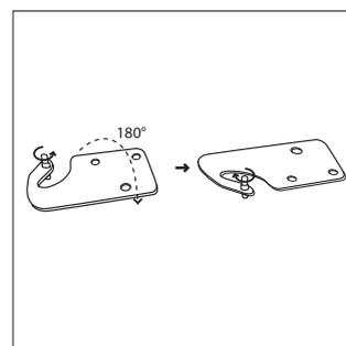
10. Helyezze vissza a felső ajtót. A felső tartó végleges becsavarozása előtt győződjön meg arról, hogy az ajtó vízszintesen és függőlegesen vonalban van-e és a tömítés minden oldalon megfelelően helyezkedik-e el. Ezután helyezze el a felfüggesztést és csavarozza azt a készülék felső részéhez.
