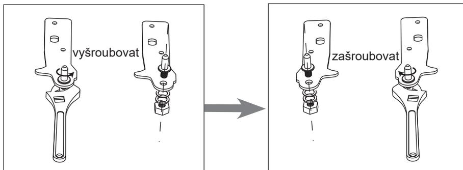
7. Nasadíte konzoli na kolík spodního závěs. Vraťte zpět obě nastavitelné nožky. Spodní dveře přesuňte na požadovanou pozici.
