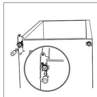
8. Otočte stredný záves o 180 °, potom ho presuňte na ľavú stranu. Zasuňte kolík stredného závesu do horného otvoru spodných dverí a dotiahnite skrutky.
