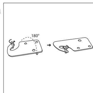
10. Nasadíte horné dvere späť. Než definitívne zaskrutkujete horný záves, skontrolujte, či dvere horizontálne aj vertikálne doliehajú a či tesnenie po všetkých stranách správne dosadá. Potom priložte záves a zaskrutkujte ho do hornej časti spotrebiča.
