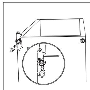
8. Otočte střední závěs o 180°, poté jej přesuňte na levou stranu. Zasuňte kolík středního závěsu do horního otvoru spodních dveří a dotáhněte šrouby.
