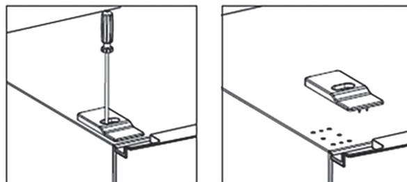
3. Odoberte horné dvere, vytiahnite skrutku zo stredného závesu pomocou krížového skrutkovača a potom odstráňte aj spodné dvere.
