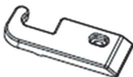
1. Odšroubujte kryt horního závěsu a poté odšroubujte horní závěs. Následně zvedněte dvířka a položte je na měkkou podložku, aby nedošlo k jejich poškrábání a poškození.
