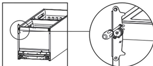
7. Instalujte spodní dveře, nastavte polohu a namontujte střední závěs na tělo chladničky.
