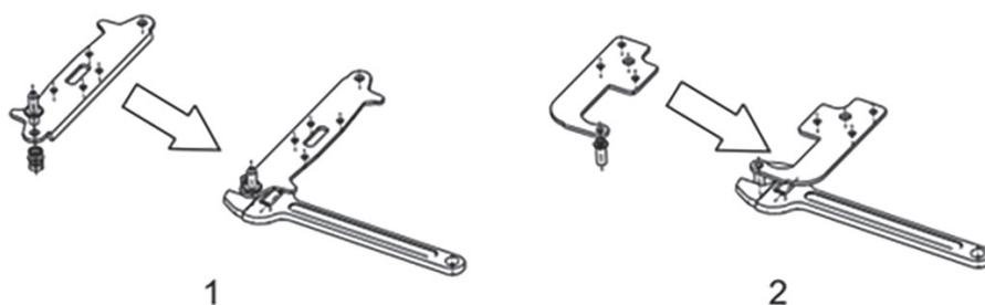
6. Inštalujte na chladničku spodný záves podľa obrázku nižšie. Otáčaním nastavovacích nožičiek sa uistite, že je chladnička v horizontálnej polohe.
