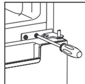
4. Položte ledničku, demontujte nastavovací nožky dle obrázku níže a poté pomocí křížového šroubováku odejměte spodní závěs.
