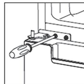
8. Nasadte späť horné dvierka. Uistite sa, že dvierka horizontálne a vertikálne dosadajú tak, aby tesnenie na všetkých stranách dosadalo a až potom dotiahnite horný záves. Potom otočte horný záves a priskrutkujte ho na hornú stranu jednotky a následne pripevnite kryt závesu (z vrečka s príslušenstvom) pomocou skrutky.
