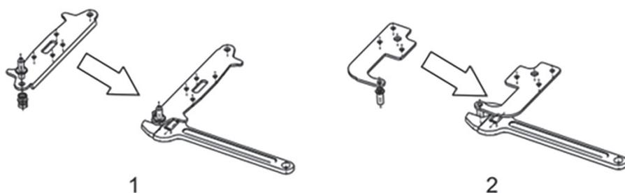
6. Instalujte na chladničku spodní závěs dle obrázku níže. Otáčením nastavovacích nožek se ujistěte, že je chladnička v horizontální poloze.
