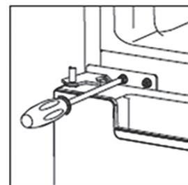
8. Nasadte zpět horní dvířka. Ujistěte se, že dvířka horizontálně a vertikálně líčují tak, aby těsnění na všech stranách dosedalo a až poté dotáhněte horní závěs. Poté otočte horní závěs a přišroubujte jej na horní stranu jednotky a následně připevněte kryt závěsu (ze sáčku s příslušenstvím) pomocí šroubu.
