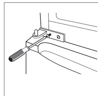
10. Nasadíte horné dvere späť. Než definitívne zaskrutkujete horný záves, skontrolujte, či dvere horizontálne aj vertikálne doliehajú a či tesnenie po všetkých stranách správne dosadá.
