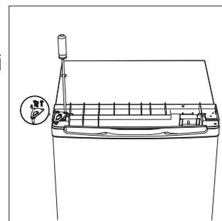
11. Nasadíte horný kryt a pripevníte ho pomocou 2 skrutiek na zadnej strane.
