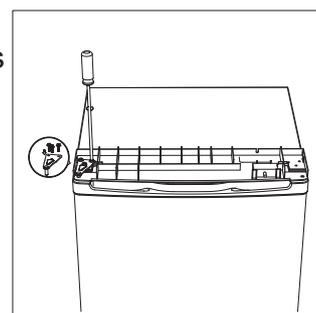
11. Nasadte horní kryt a připevněte jej pomocí 2 šroubů na zadní straně.
