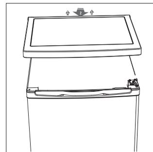
3. Odšroubujte horní závěs a poté odejměte horní dvířka. Ty položte na měkkou podložku, aby nedošlo k jejich poškrábání.
