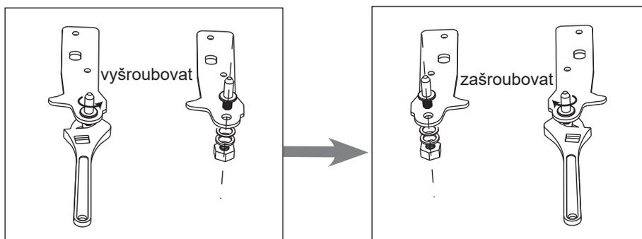
8. Nasadte konzoli na kolík spodního závěsu. Vraťte zpět obě nastavitelné nožky. Spodní dveře přesuňte na požadovanou pozici.
