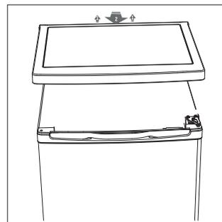
3. Odskrutkujte horný záves a potom odoberte horné dvere. Tie položte na mäkkú podložku, aby sa predišlo poškriabaniu.
