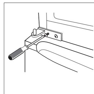
10. Helyezze vissza a felső ajtót! A felső tartó rögzítése előtt ellenőrizze, hogy az ajtó megfelelő pozícióban van-e elhelyezve, beleértve a tömítéseket is!
