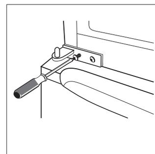
10. Nasadte horní dveře zpět. Než definitivně zašroubujete horní závěs zkontrolujte, zda dveře horizontálně i vertikálně lícují a zda těsnění po všech stranách správně dosedá.
