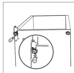
9. Forgassa el a középső tartót 180°-al, utána helyezze azt át bal oldalra! Tegye be a középső tartó csavarját az alsó ajtóba és rögzítse a csavarokat!
