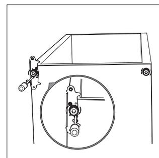
9. Otočte střední závěs o 180°, poté jej přesuňte na levou stranu. Zasuňte kolík středního závěsu do horního otvoru spodních dveří a dotáhněte šrouby.
