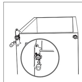
9. Otočte stredný záves o 180 °, potom ho presuňte na ľavú stranu. Zasuňte kolík stredného závesu do horného otvoru spodných dverí a dotiahnite skrutky.
