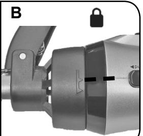
Przesuń przełącznik **A1** do pozycji **1** lub do pozycji **2**. Urządzenie wyłącza przesuwając przełącznik **A1** do pozycji **0**. Końcówkę z jednostki napędowej zdejmij, naciskając przycisk blokowania **A3**, końcówkę obróć w lewo i ciągnąc zdejmij. Przy wymianie końcówek bądź ostrożny, mogą być gorące.
